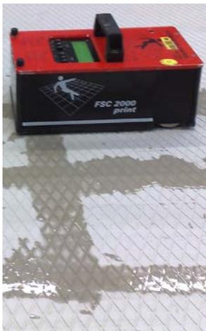
Ein Betonabdruck der GIAN® 1-Karo wird mit dem FSC 2000 Print bei nassem Boden getestet.
