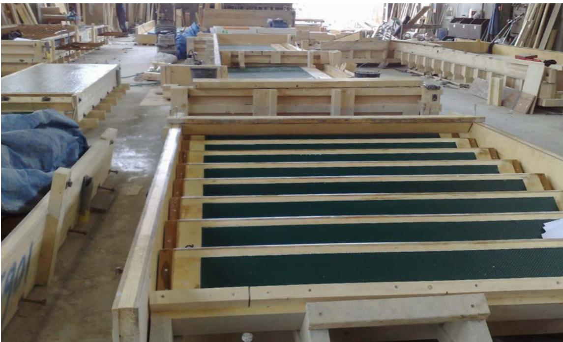
*Beispiele für hölzerne Betonformen mit integrierter GIAN® -Strukturmatte.*
