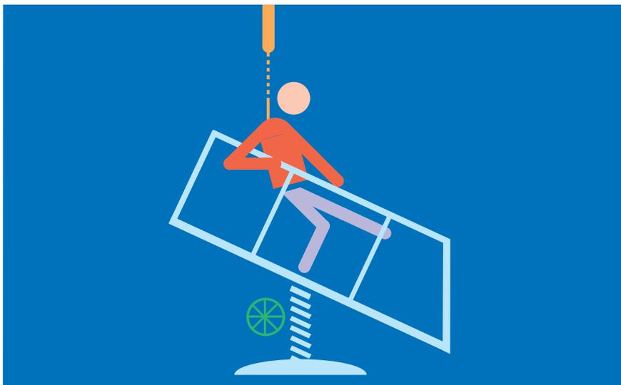
*Während dieses Tests, der nur in Labors durchgeführt wird, wird die Neigung stufenweise erhöht. Je größer der Neigungswinkel, bei dem die Personen zu rutschen beginnen, desto höher der R-Wert.*
